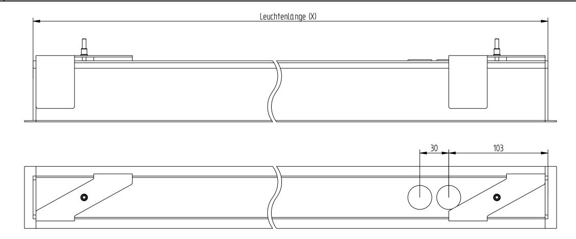
Hinweis: die Klemmstärke kann durch den Einsatz einer längeren Schraube (DIN7985 M4x35) auf 10-25mm erhöht werden – bitte bei Bedarf bei der Bestellung angeben. Daraus resultierend erhöhte Einbautiefe (95mm) beachten!
