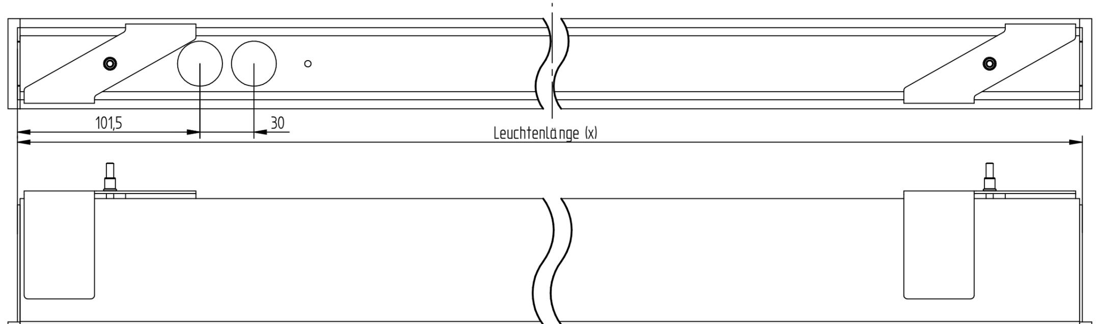
Hinweis: die Klemmstärke kann durch den Einsatz einer längeren Schraube (DIN7985 M4x35) auf 10-25mm erhöht werden
