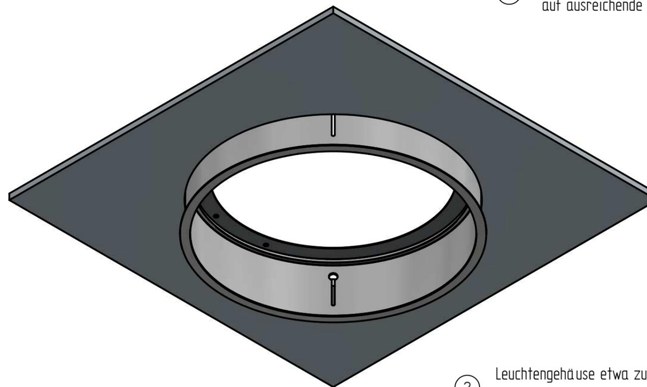
② Leuchtengehäuse etwa zur Hälfte in den Deckenausschnitt einschieben
