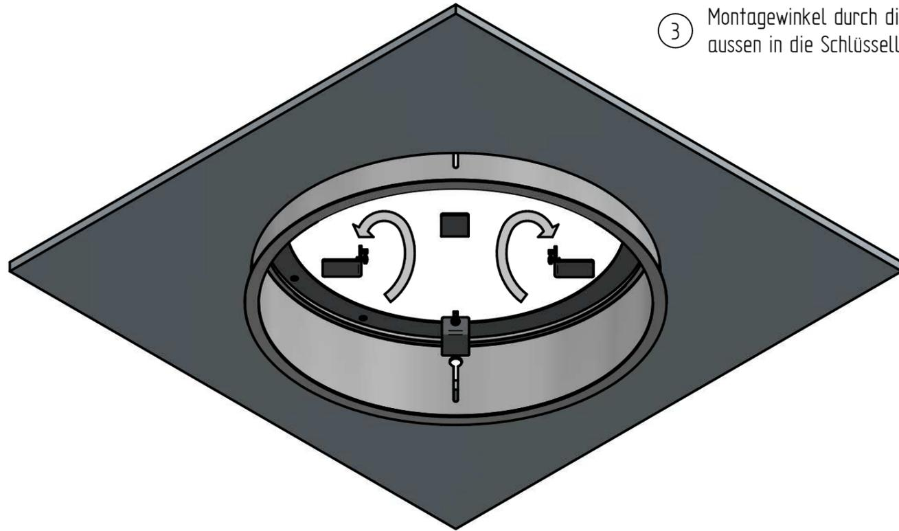
⑤ Einbaugehäuse gegen die Decke schieben; dabei gleiten die Montagewinkel im Befestigungsschlitz nach unten.
